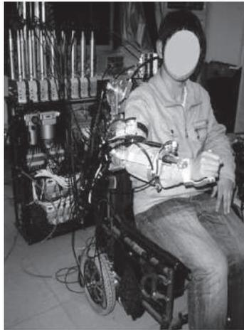
Figura 21: Prototipo del robot de rehabilitación de 10 GDL, 6 de ellos para el mecanismo del hombro. Imagen tomada de [16].
