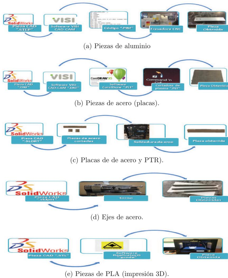
Figura 73: Procedimientos para la obtención de las geometrías deseadas para las piezas.
