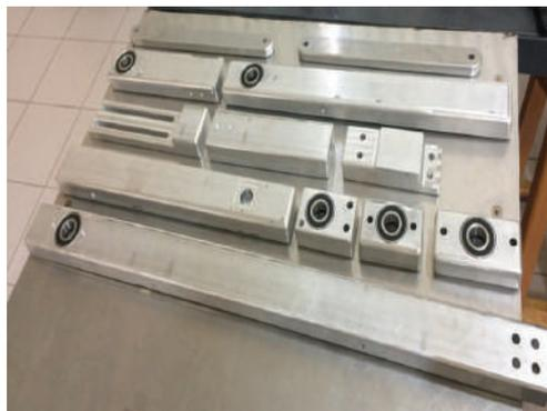
Figura 75: Piezas de aluminio con rodamientos.
