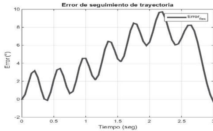
Figura 86: Gráfica del error de seguimiento para el movimiento de flexión a 90° en 3 seg.
