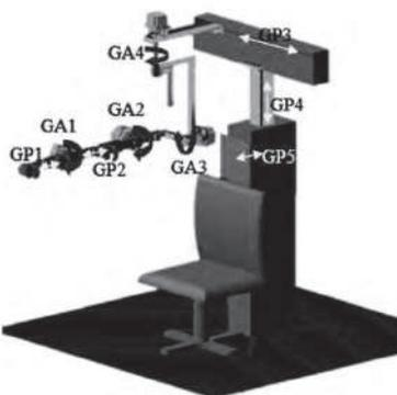
Figura 23: Ensamble del prototipo realizado mostrando los grados de libertad activos y pasivos (GA= grado de libertad activo y GP= grado de libertad pasivo). Imagen tomada de [5].
