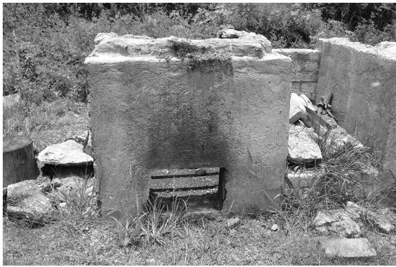
Figura 10. Sistema de hornillas mejorados para la destilación del mezcal en Río Azucena: a) Hornillas de ladrillo. b) cargadores metálicos para un depósito de 200 L.
