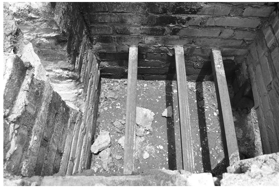
Figura 10. Sistema de hornillas mejorados para la destilación del mezcal en Río Azucena: a) Hornillas de ladrillo. b) cargadores metálicos para un depósito de 200 L.
