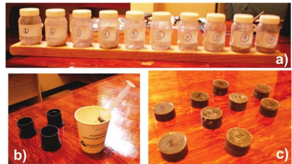
Figura 3. a) Muestras de arenas colectadas en Tequistepec, b) preparación de la mezcla de resina y arenas para su posterior depósito en los moldes para su consolidación, c) Probetas consolidadas de la mezcla después de endurecerse la resina.
