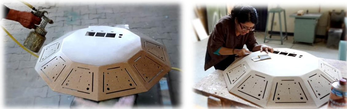
Figura 5.22. Carcasa: Ensamble y acabados.
