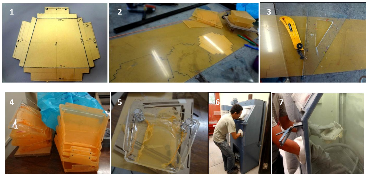
Figura 5.19. Manufactura manual de los botones: Patrón (1), acrílico (2), cortes (3), cejas dobladas (4), probando resortes (5), máquina de sandblasting (6), botón con opacidad (7).
