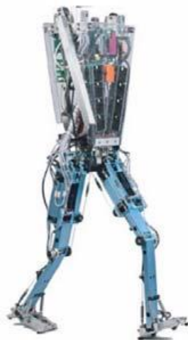
Figura 1.4: Primer prototipo del bípido ESBiRRo [4].
