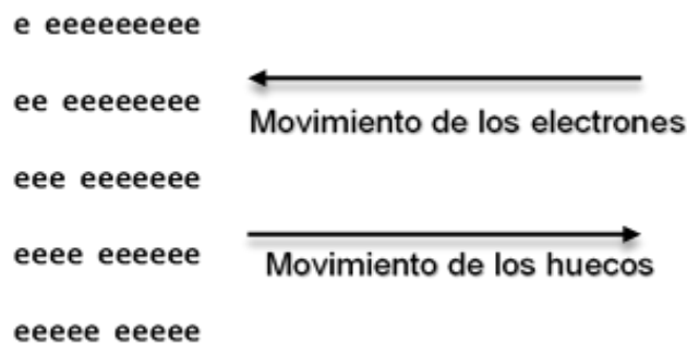
Fig. 6. Los electrones y los huecos se mueven en direcciones opuestas.
