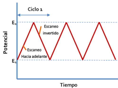
Fig. 17. Variación del potencial aplicado como función del tiempo en un experimento de voltamperometría cíclica.
