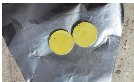
Fig. 48. Pastillas Cerámicas \text{SnO}_2\text{-Sb}_2\text{O}_3 después del depósito a temperatura ambiente por 4 horas.
