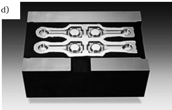
Fig. 3. Forja de aluminio: a) Dado abierto, b) Dado impresor, c) Forjado sin rebaba, y d) Dado de forja.
