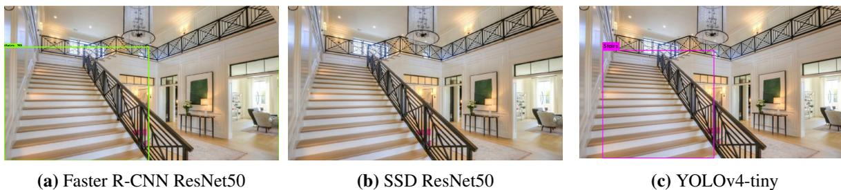
Figura 3.6. Detección de escaleras en imagen de prueba.
