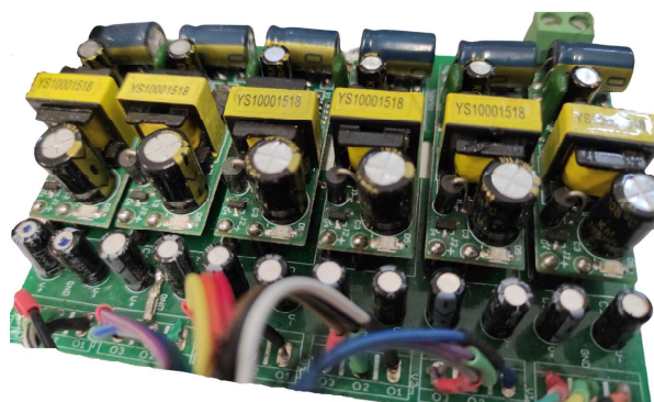
Figura A.3: Fuente de alimentación de los impulsores de compuerta.
