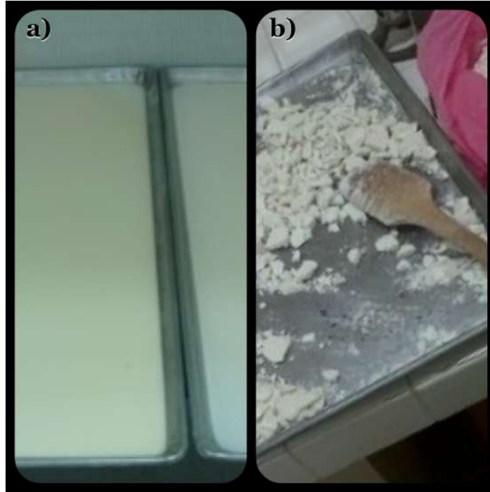
Figura 41. Preparación del inoculante usando almidón como acarreador. a) Se observan las charolas de aluminio sobre las que se llevó a cabo el secado del material. b) El polvo una vez seco.
