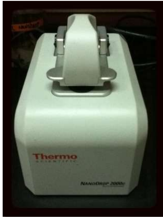
Figura 13. NanoDrop empleado para medir la concentración de ADN.
