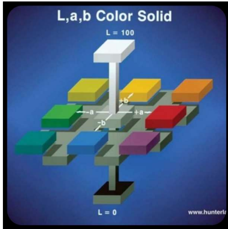
Figura 6. Parámetros de medición de color CIELab.
