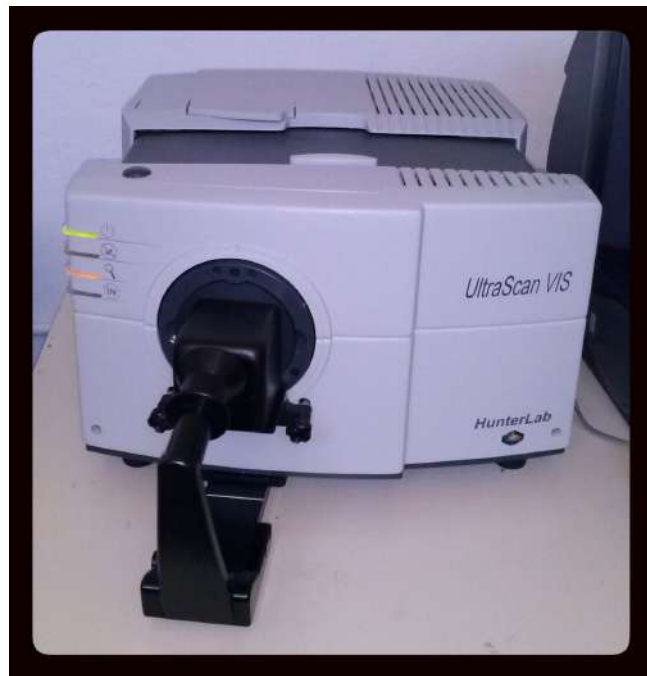
Figura 14. Colorímetro HunterLab empleado para la determinación del color en el medio MMV.
