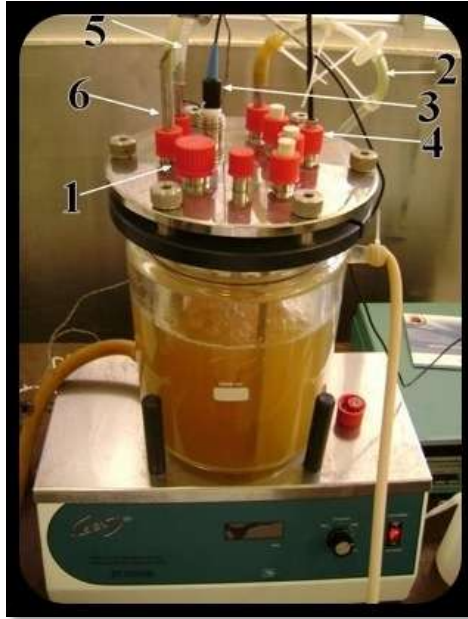
Figura 15. Reactor piloto de 3 L, para el crecimiento de B. licheniformis .
