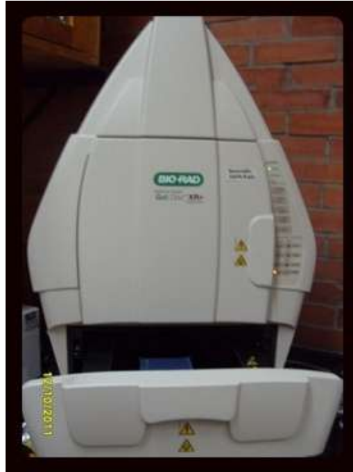
Figura 1. Fotodocumentador empleado para el revelado del gel después de la electroforesis en gel de agarosa.
