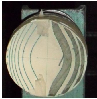
Fig. 8. Ronchigrama ideal colocado en la superficie bajo prueba.
