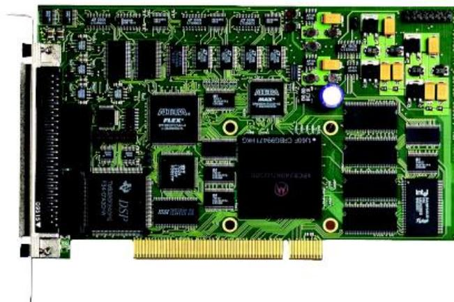
Figura 6.7: Tarjeta controladora DS1104 R&D.
