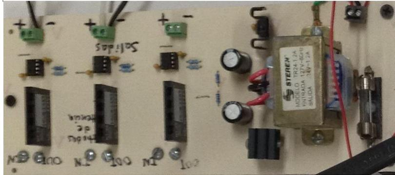
Figura 6.5: Sensores de corriente
