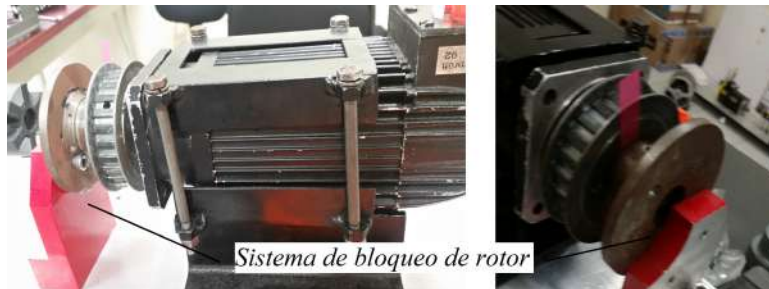
Figura 3.8: Sistema mecánico utilizado en la prueba de rotor bloqueado.
