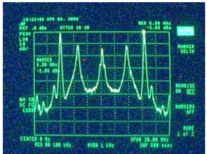
FOTOGRAFÍA 1 ESPECTRO DE LA MULTICANALIZACIÓN DE LA PORTADORA DE AUDIO Y UNA SEÑAL SINUSOIDAL DE 2 MHz
