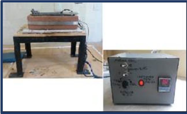
Fig. 4.10 Calefactor y controlador de temperatura implementados en el sistema RPU a nivel laboratorio.
