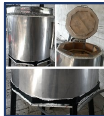
Fig. A.14 Colocación de colcha térmica en el cuerpo, tapa y parte inferior de la base del horno.
