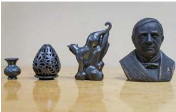
Fig. 4.17 Artesanías de barro negro con película de \text{Al}_2\text{O}_3:\text{Ce}^{3+} , sin excitación de luz UV.
