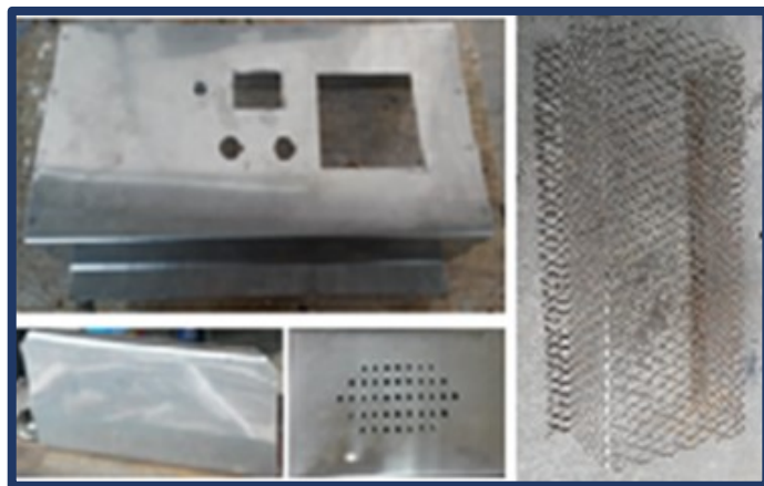
Fig. A.16 Gabinete de control y ventilación.
