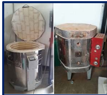
Fig. 3.3 Hornos eléctricos por resistencias del taller de cerámica.
