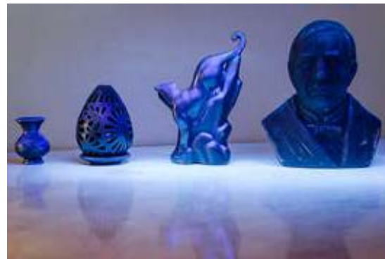
Fig. 4.18 Artesanías de barro negro con película de \text{Al}_2\text{O}_3:\text{Ce}^{3+} , con excitación de luz UV a 302 nm.
