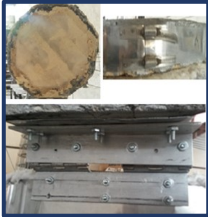
Fig. A.11 Tapa de tabique refractario, cinta de sujeción de lámina de acero inoxidable y soportes con bisagras.
