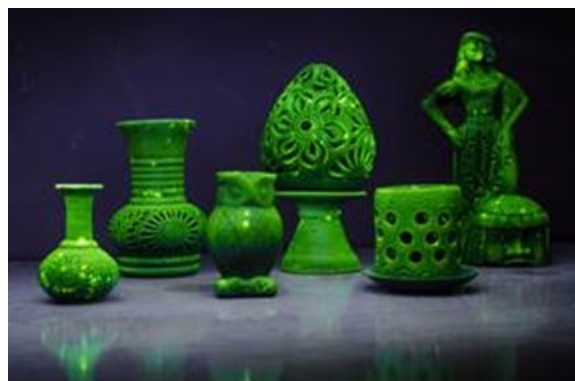
Fig. 4.20 Artesanías de barro negro con película de \text{Al}_2\text{O}_3:\text{Tb}^{3+} , con excitación de luz UV a 254 nm.
