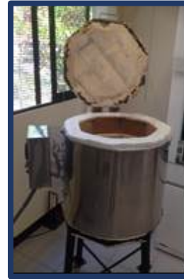
Fig. 4.11 Horno eléctrico de resistencias implementado en el sistema RPU escalable a nivel industrial.
