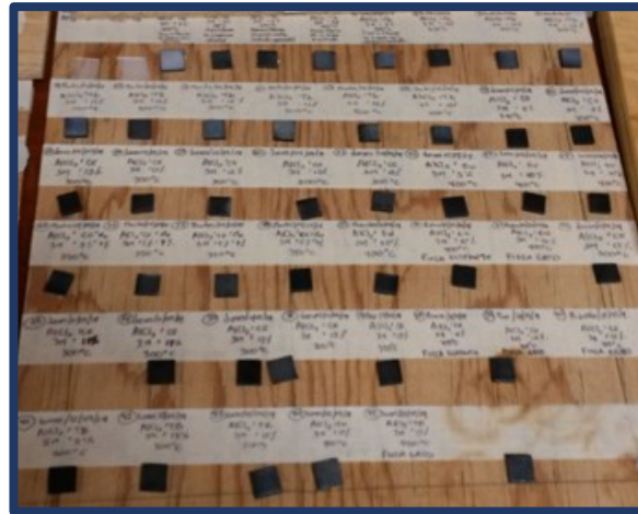
Fig. 4.1 Muestras de sustratos de barro negro con película \text{Al}_2\text{O}_3:\text{Ce}^{3+} , \text{Al}_2\text{O}_3:\text{Tb}^{3+} y \text{Al}_2\text{O}_3:\text{Eu}^{3+} .
