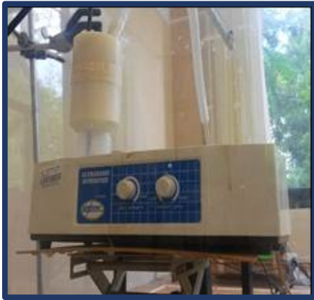
Fig. 4.7 Un generador ultrasónico implementado en el sistema RPU a nivel laboratorio.
