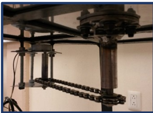
Fig. A.13 Colocación de engranes, cadena de transmisión y motor sobre la parte inferior de la base del horno.
