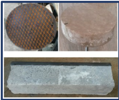
Fig. A.9 Base giratoria y tapón de ventana con cemento refractario.
