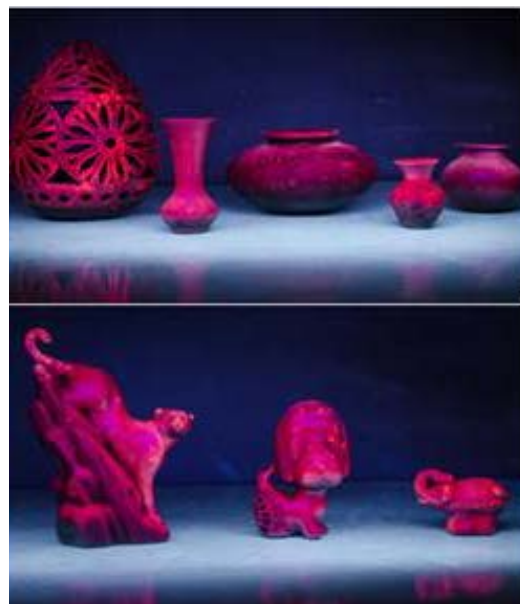
Fig. 4.22 Artesanías de barro negro con película de \text{Al}_2\text{O}_3:\text{Eu}^{3+} , con excitación de luz UV a 254 nm.
