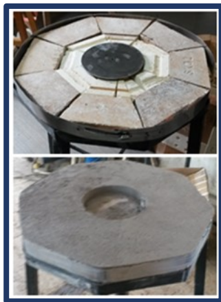
Fig. A.7 Base con ladrillos y cemento refractario.
