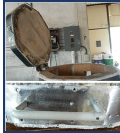
Fig. A.12 Cable de acero para el soporte de la tapa y agarradera para su manipulación.
