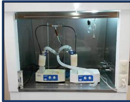
Fig. 4.8 Dos generadores ultrasónicos implementados en el sistema RPU escalable a nivel industrial.
