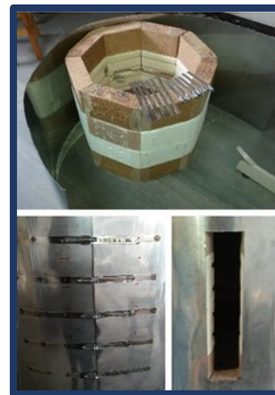
Fig. A.8 Cuerpo de horno con lámina, abrazaderas y ventana.
