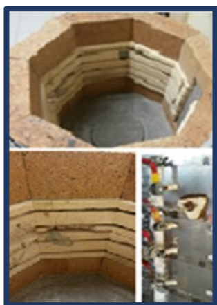
Fig. A.17 Colocación de resistencias y termopar en el interior del horno.
