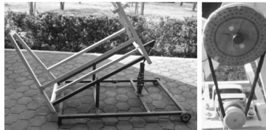
Figura 5. Mecanismos para seguimiento de altura angular y ángulo azimut
