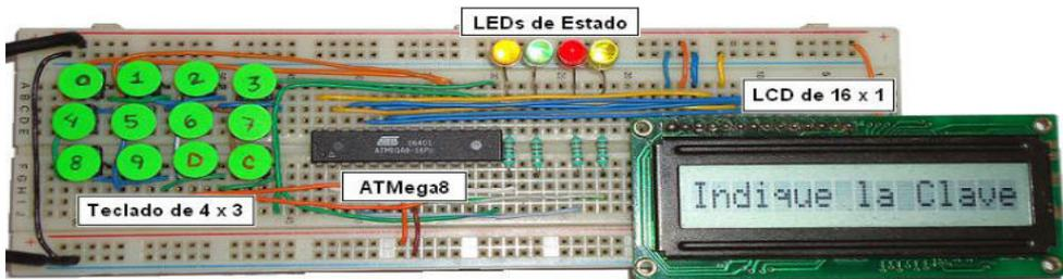
Figura 9.14 Implementación del hardware correspondiente a la chapa electrónica
