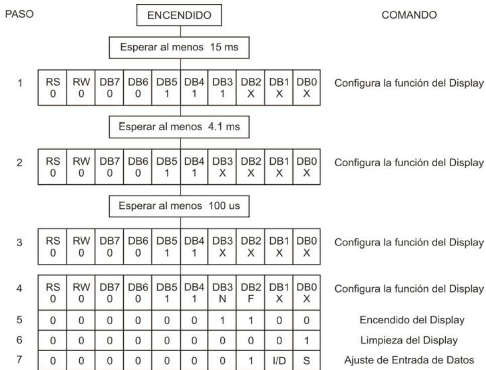
Figura 8.19 Secuencia para inicializar un LCD con una interfaz de 8 bits
