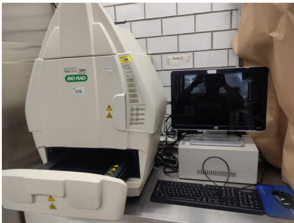
Fig. 15. Fotodocumentador Molecular Imager Gel-Doc™ XR+ System
