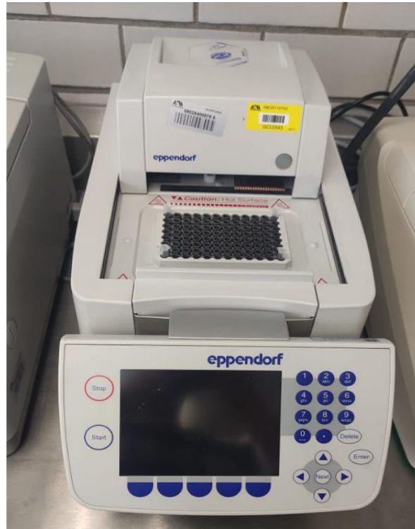
Fig. 14. Termociclador Mastercycle Epgradient Modelo 5341 (Eppendorf, Hamburg, Alemania)
