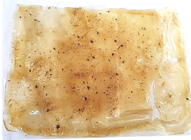
Figura 27. Biomaterial a base de celulosa de Pochote. Elaboración propia.
