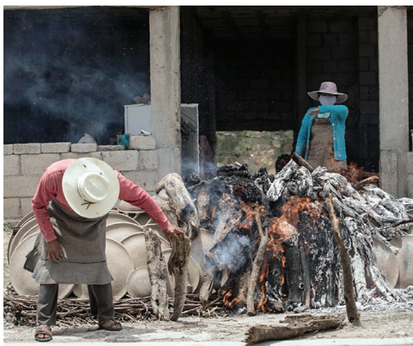
Figura 24. Quema de comales al aire libre en Los Reyes Metzontla, Puebla. Foto: Edmundo Saavedra Cruz.
