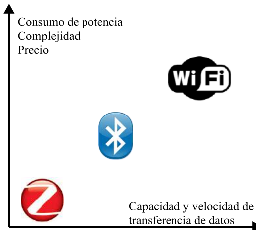
Figura 1.4. Comparación de los protocolos ZigBee, Bluetooth y Wi-Fi [Cano, 2010].
